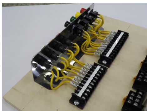
図4 ランプとスイッチ 配線の状態
