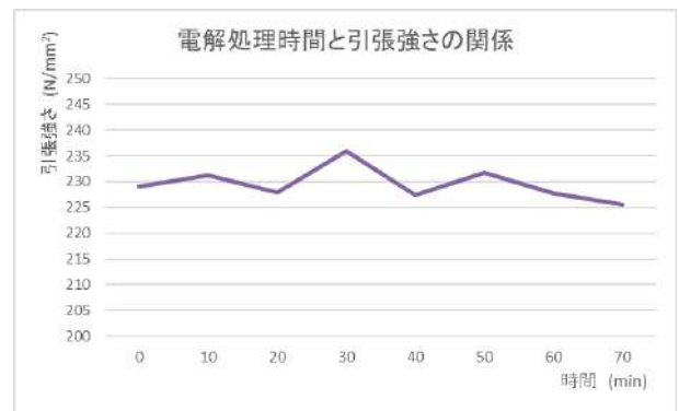
図5 電解処理時間と引張強さの関係
