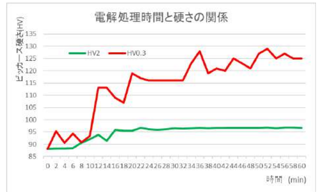
図4 電解処理時間と硬さの関係(HV)
