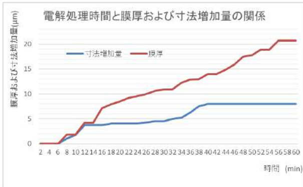
図3 電解処理時間と膜厚及び寸法増加量の関係
