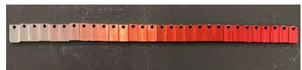
図2 アルマイト処理後の試験片
